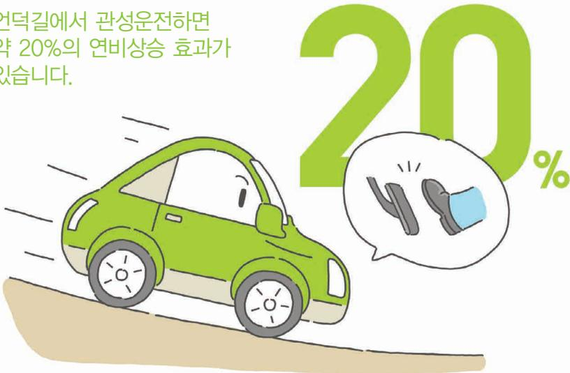
평소 도로 내리막길에서 자동차의 연료 차단기능(Fuel cut)\*을 적극 활용하는 등 ‘관성운전’을 생활화 해보세요. 6km의 경사구간을 관성운전 패턴으로 운전했을 경우, 평균속도는 정속 80km/h와 비슷하였으나, 정속 60km/h 주행 시보다 높은 연비를 얻을 수 있습니다. 이처럼 연료 차단기능을 활용하면 오염물질 배출과 연료소비를 20% 이상 줄일 수 있습니다.
